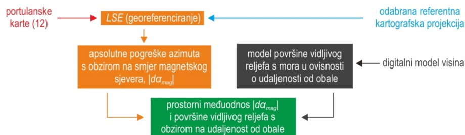
Slika 6—15. Pojednostavljeni prikaz temeljnih metodoloških postupaka primijenjenih za utvrđivanje upotrjebljivosti portulanskih karata s obzirom na vidljivost reljefa s mora u ovisnosti o udaljenosti od obale.
