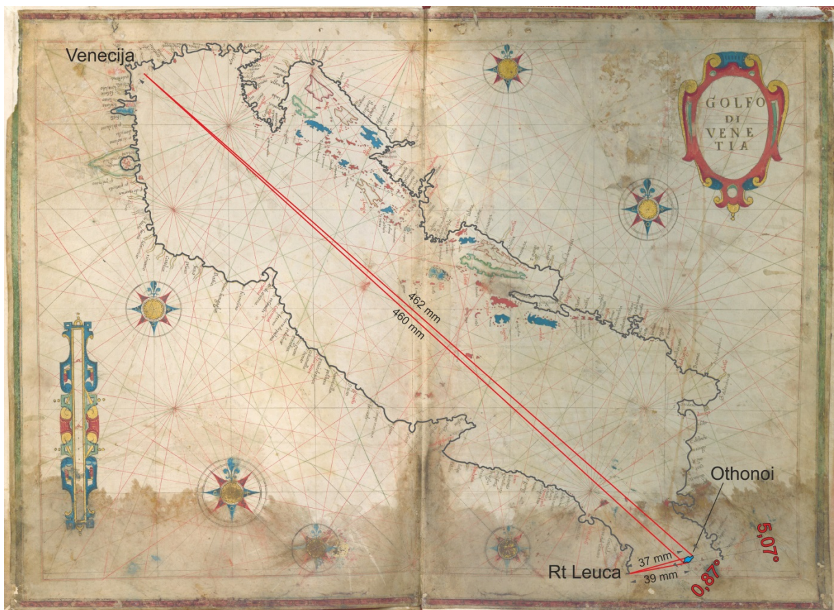
Slika 6—34. Maksimalne pogreške očitavanja kursa na karti VDVb 1593. za rute Venecija – Othonoi (duljine oko 461 mm na karti) i Rt Leuca – Othonoi (duljine oko 38 mm na karti).
