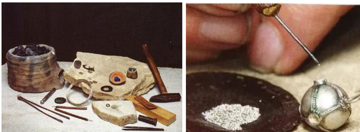
Slika 1. Prikaz alata potrebnog za izradu zlatarskih proizvoda i primjena tehnike granulacije (M. PETRINEC, 2019., 59)
