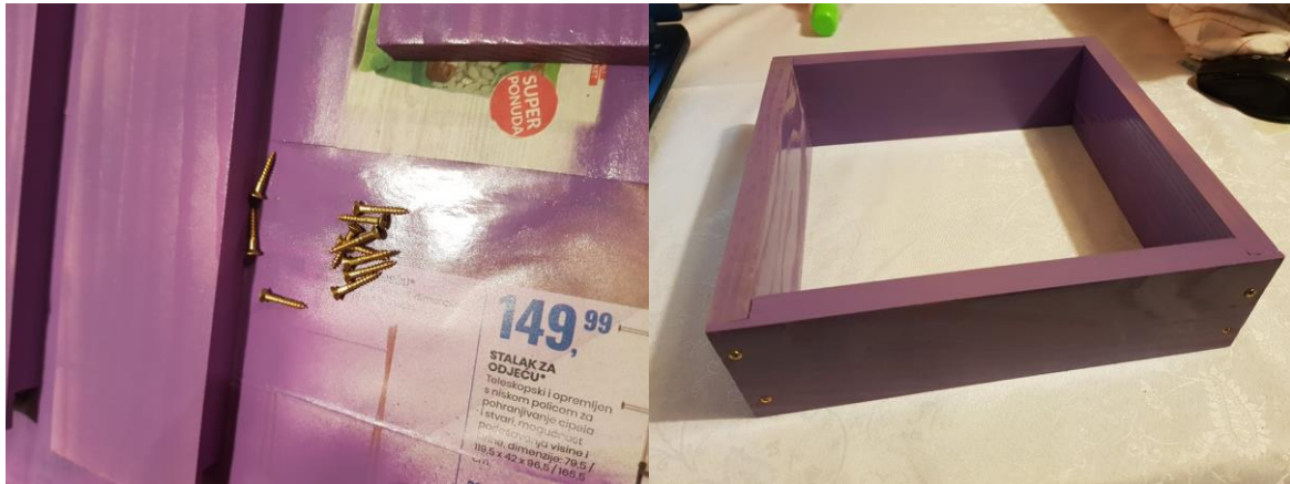
Slika 21: Spajanje letvica vijcima
