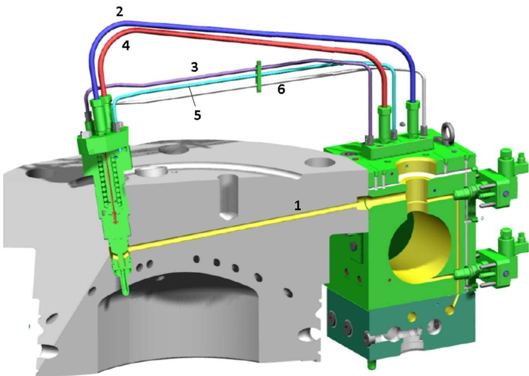
Slika 11: Mediji i spojevi sustava ubrizgavanja plinovitog goriva [8]
