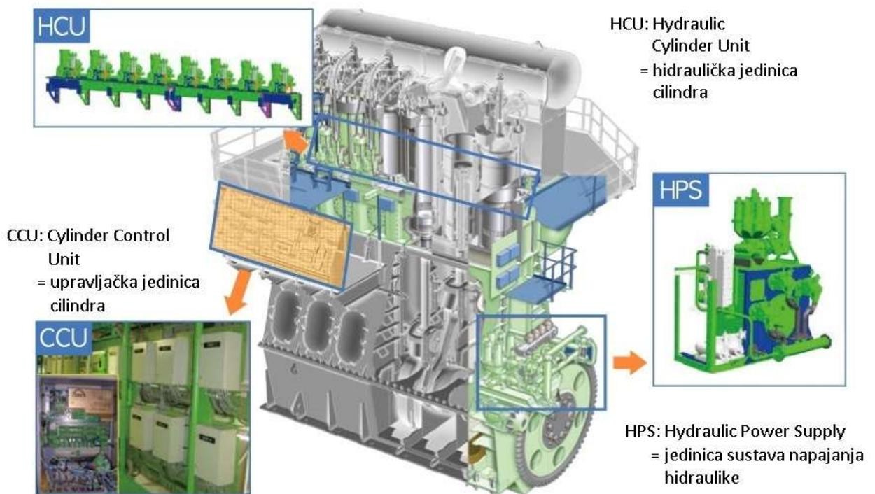
Slika 1: Novi dijelovi motora kod „ME“ izvedbe [6]
