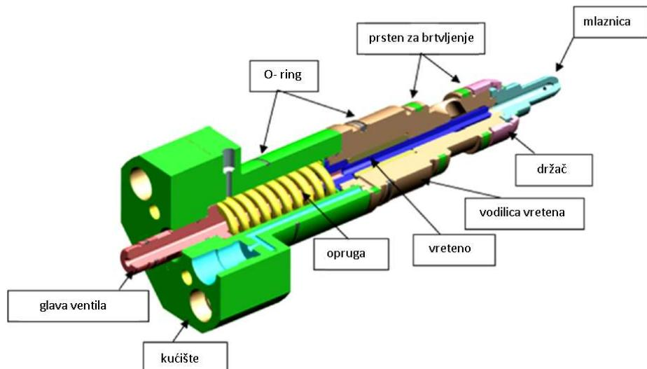
Slika 8: Dijelovi rasprskača plinovitog goriva [8]
