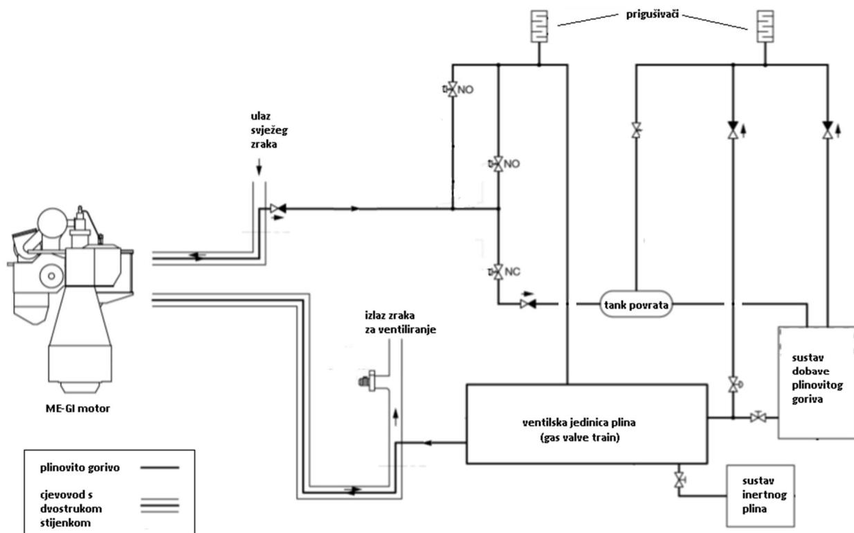
Slika 18: Pojednostavljena shema povrata plinovitog goriva [1]
