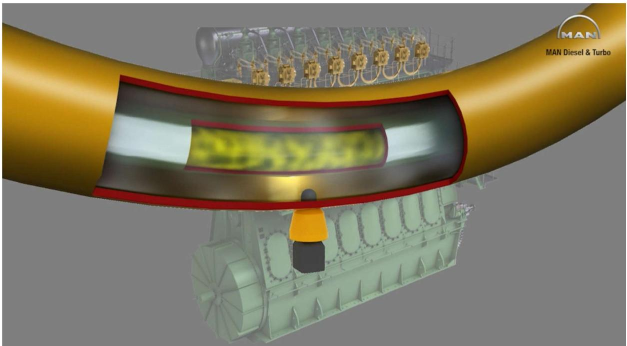
Slika 2: Cjevovod s dvostrukom stijenkama [7]
