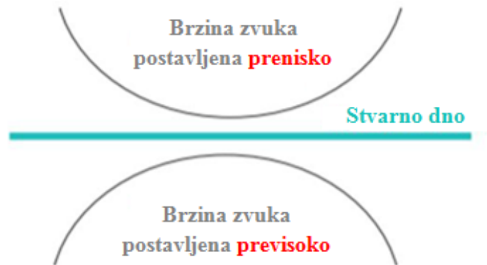
Slika 28. Netočnosti prikaza morskog dna zbog pogrešne brzine zvuka
