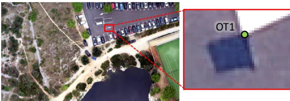
Slika 7. Primjer označene orijentacijske točke OT1
