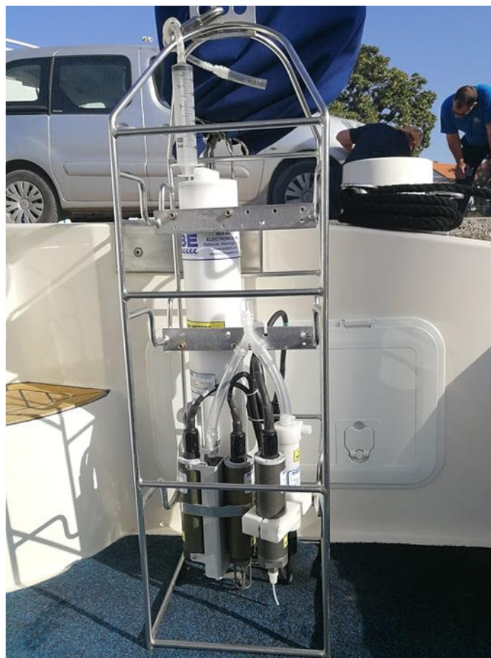
Slika 12. ECD sonda za mjerenje saliniteta i temperature
