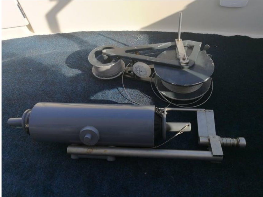
Slika 11. Niskinov crpac za uzimanje uzoraka morske vode
