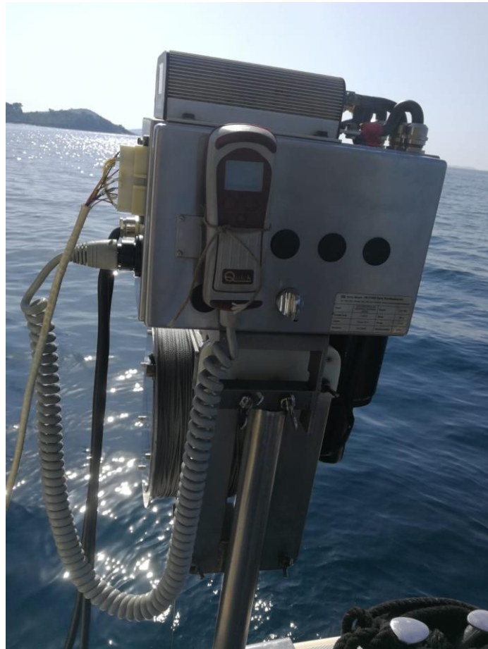
Slika 10. Vinč sa kojim se spušta sonda
