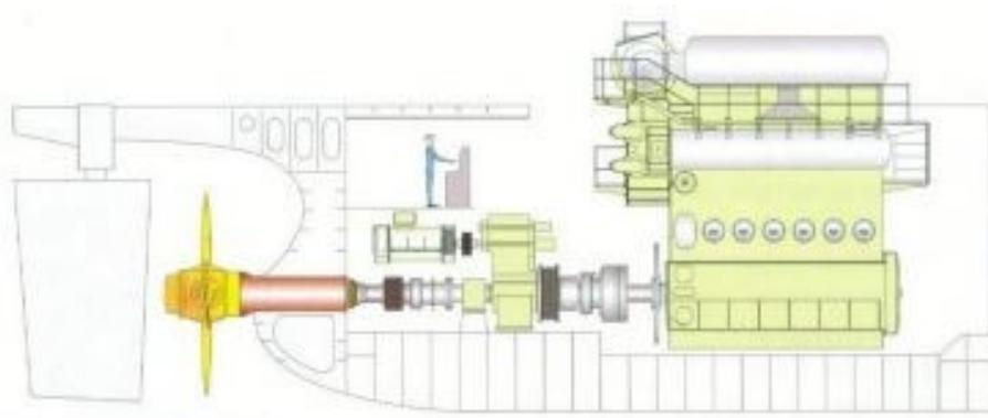
**Slika 1.** Direktni prijenos snage kao standard kod sporookretnih dvotaktnih motora s križnom glavom
