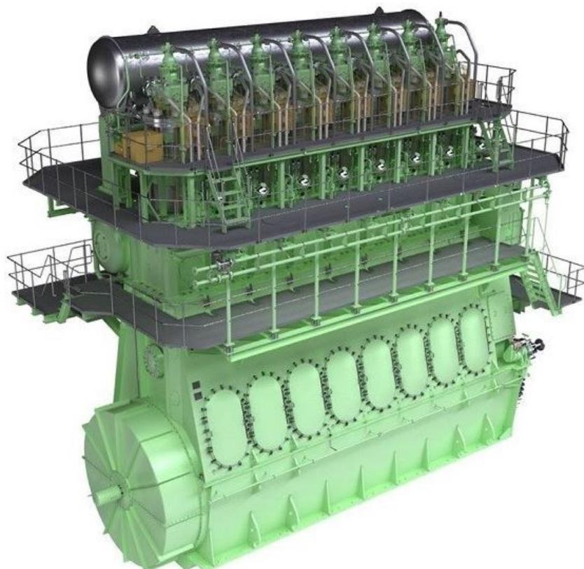
Slika 2. Sporookretni dvotaktni motor s križnom glavom
