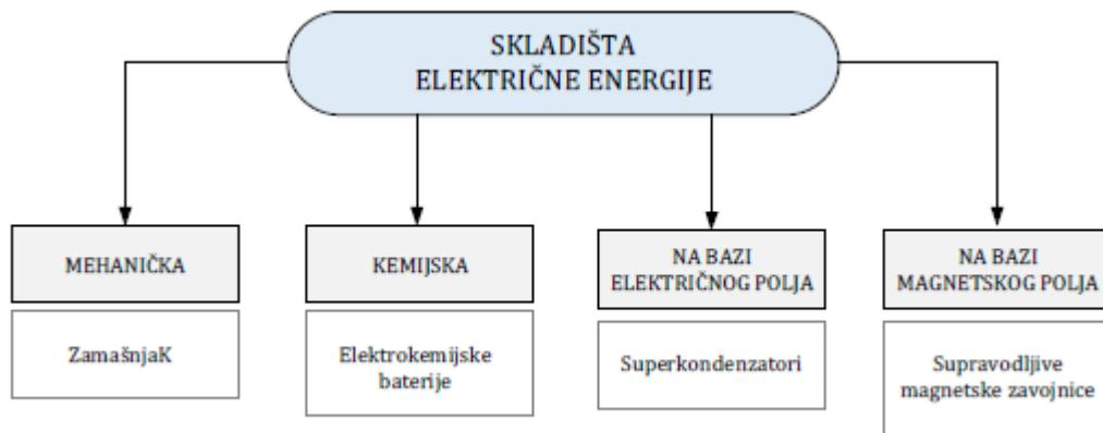
**Slika 8.** Vrste skladišta električne energije
