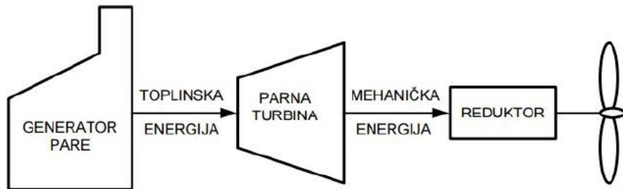
**Slika 3.** Shematski prikaz parno turbinskog postrojenja
