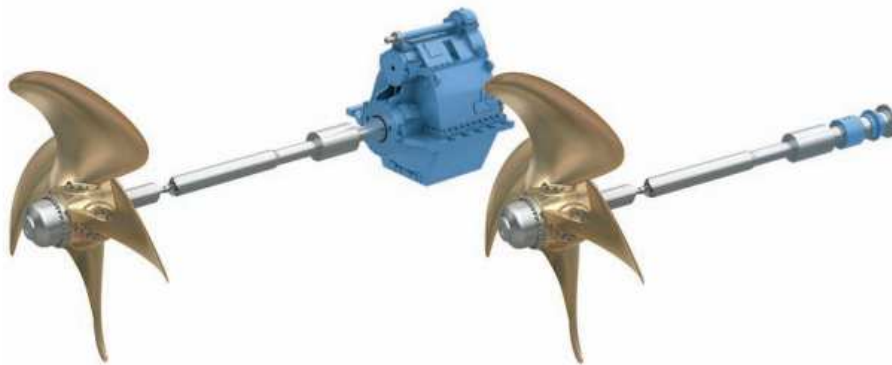
Slika 12. Propulzija s propelerom na vratilu
