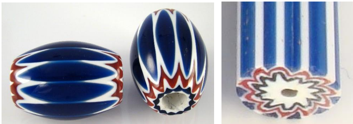
Slika 72. i 73. Gotova rozeta perlica i njezin poluproizvod, stakleni štapić ( http://www.coloradoleathergoods.com/chevrons.htm , 9. 3. 2018.)
