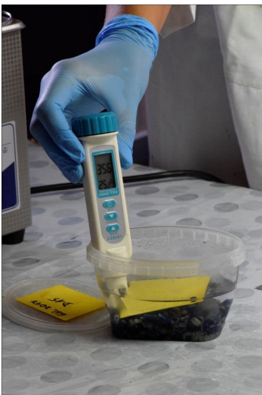
Slika 95. Mjerenje provodljivosti (foto: K. Batur, arhiva projekta Brodolom kod Gnalića – ogledalo renesansnog svijeta )
