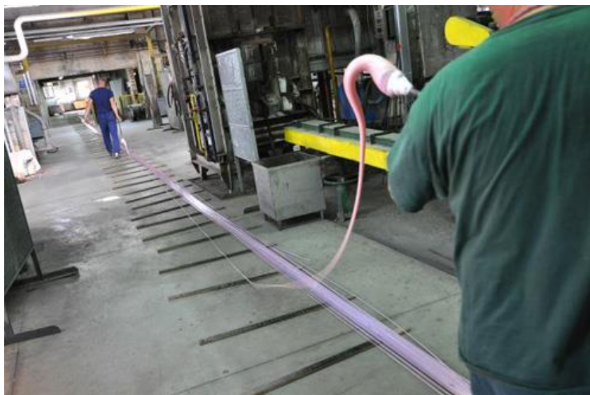
Slika 69. Današnja proizvodnja staklenih tuba ( https://www.murrina.it/en/content/4-our-factory , 2. 9. 2018.)
