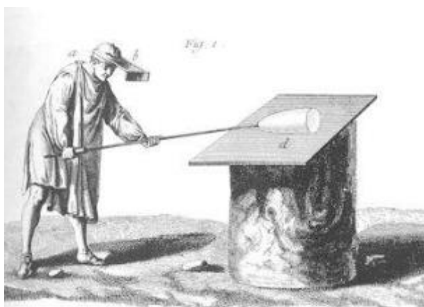
Slika 68. Obrada staklenog mjehurca na metalnoj ploči
