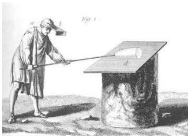
Slika 68. Obrada staklenog mjehurca na metalnoj ploči
