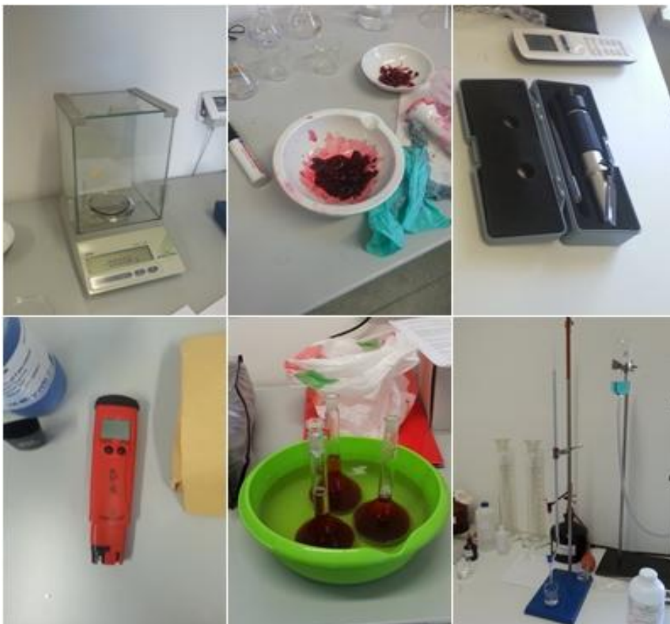
Slika 6. Kemijska analiza ploda u laboratoriju: a) analitička vaga b) keramički mužar c) refraktometar d) pH metar e) uzorci f) NaOH za titraciju ( Fotografija: orginal)
