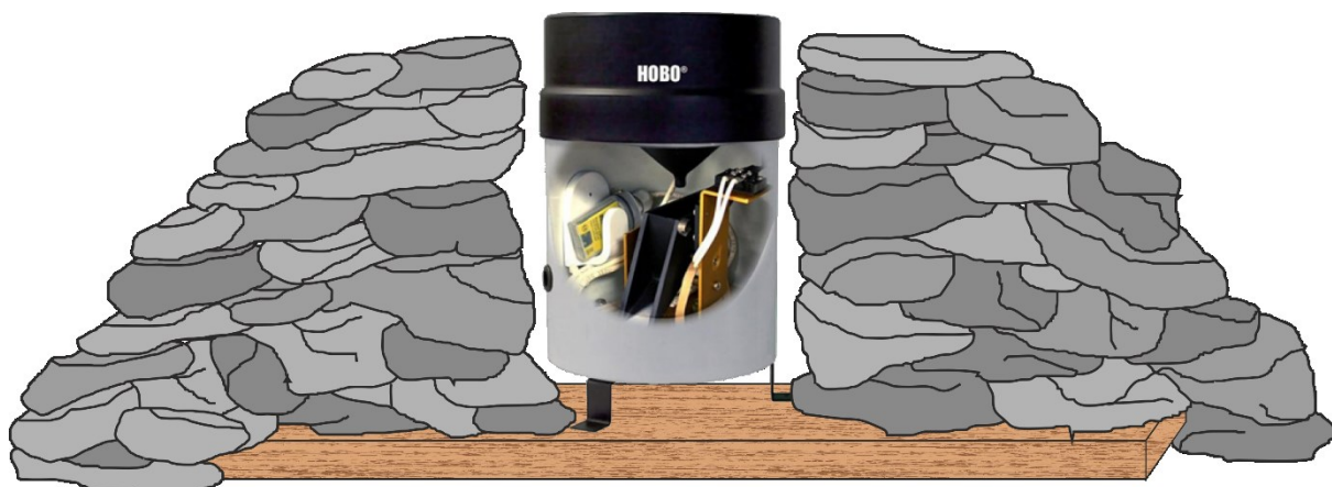
Slika 13. Unutrašnjost mjernog uređaja Hobo Onset RG3-M postavljenog na ravnu drvenu dasku i obloženog kamenjem
