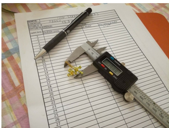
Slika 4. Mjerenje duljina cvata masline pomoću pomične mjerke
