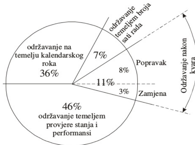
Slika 3: Učešće pojedinih tipova održavanja sustava broda (Izvor: Lovrić, Josip. Osnove brodske terotehnologije. Dubrovnik, 1989 g.)
