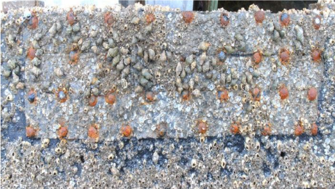
Slika 24 – Obraštaj na modelu 1 nakon njegovog vađenja iz mora (A. W. MARR, 2006, 65, fig. 11.)
