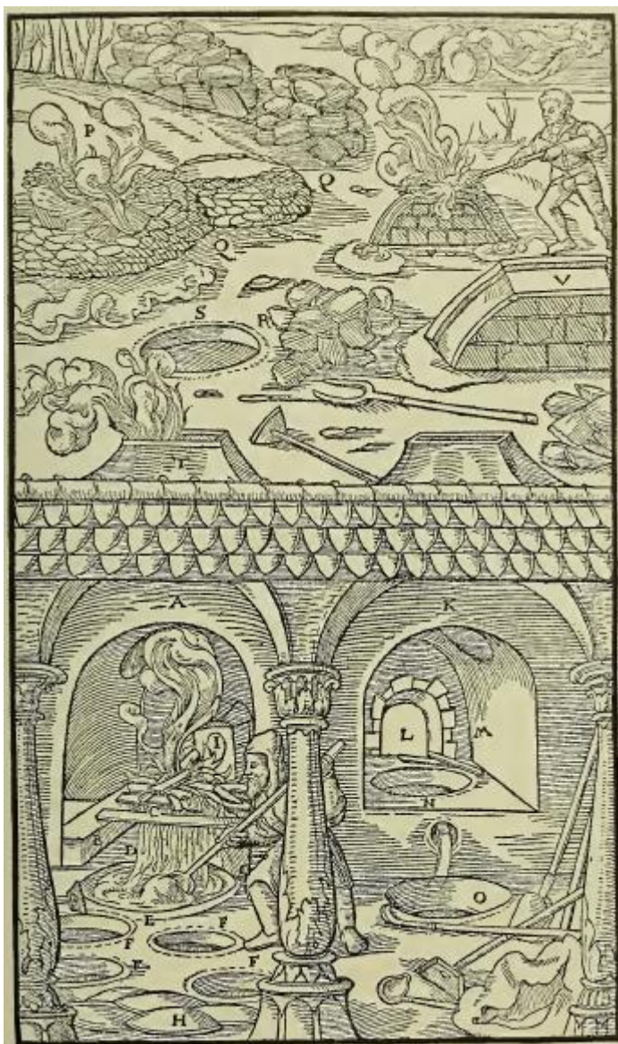
Slika 16 – Posebne peći za taljenje olovne rude: A – peć Karnia; K – peć Saksonaca; P – ognjište Vestfalijevaca; V – peći Poljaka (G. AGRICOLA, 1556, 393.)
