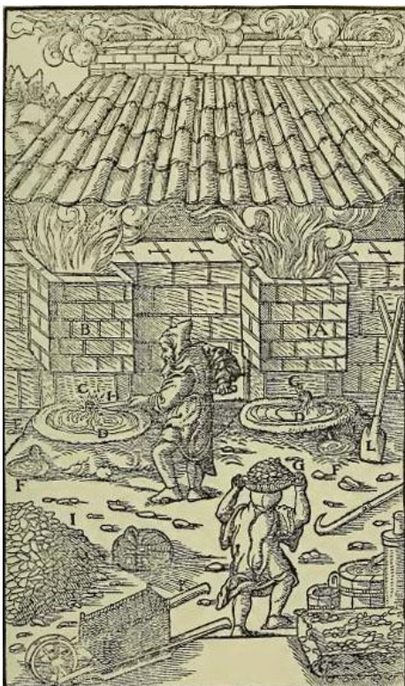
Slika 15 – Visoke peći za taljenje rude trećom metodom: A, B – peći; C – ispust; D – predognjište; F – drugo predognjište (G. AGRICOLA, 1556, 389.)
