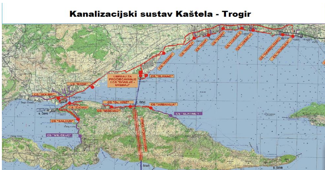
Slika 26: Brojne crpne stanice duž sjeverne obale Kaštelanskog zaljeva; CUPOV Divulje; Hidrotehnički tunel Čiovo; Podmorski ispust; Dodatna kanalizacijska mreža označena je ljubičasto (Izvor: URL13).
