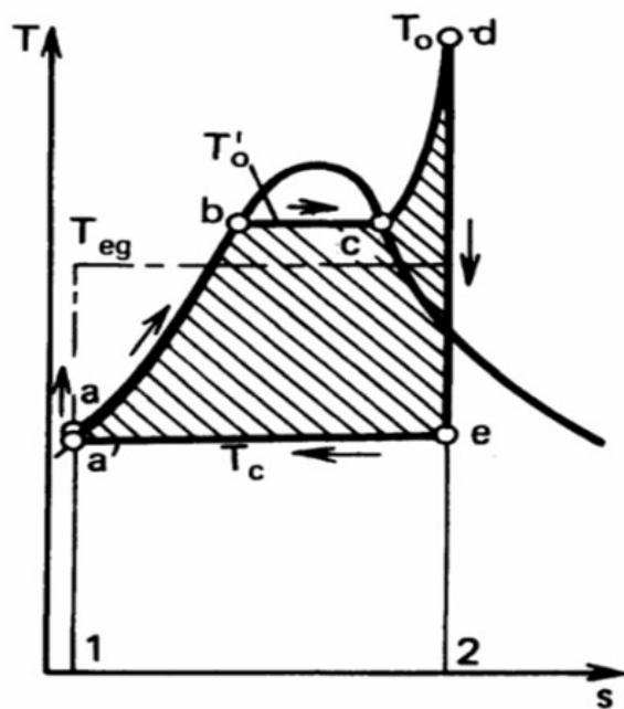
Slika 3.1-1 Pojednostavljeni RC-toplinski proces u T-s dijagramu
