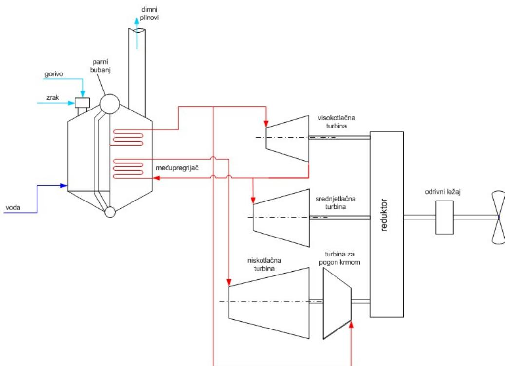
Slika 2.2-1 Pojednostavljeni prikaz sustava s međupregrijaćem pare
