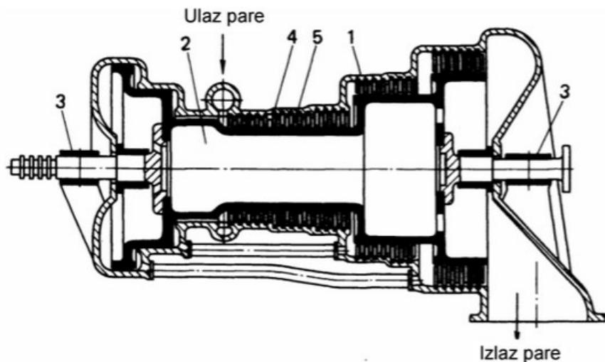
*Slika 2.3-2 Reakcijska parna turbina s više stupnjeva*
