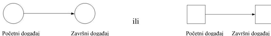
Slika 7: Primjer elementa konstrukcije mrežnog dijagrama
