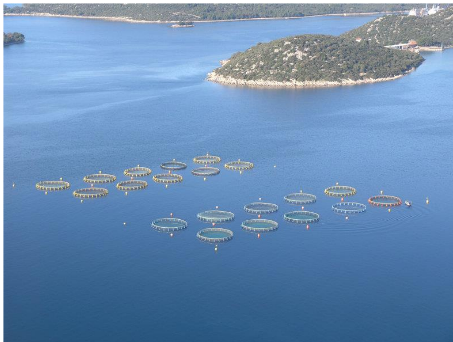
Slika 13. Uzgajalište sa postavljenim kavezima u sidrenu mrežu (Izvor: www.cromaris.hr )
