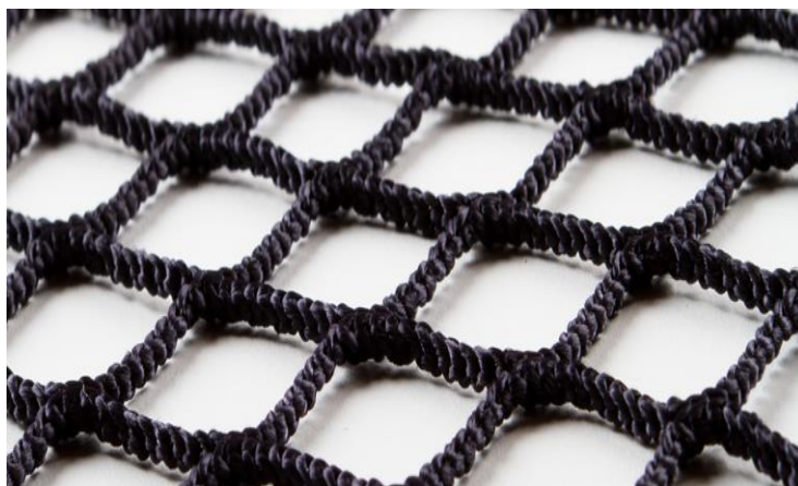
Slika 17. Prikaz materijala od poliamida (PA)
