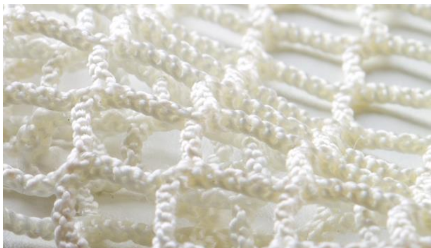
Slika 18. Prikaz materijala od poliester (PES)
