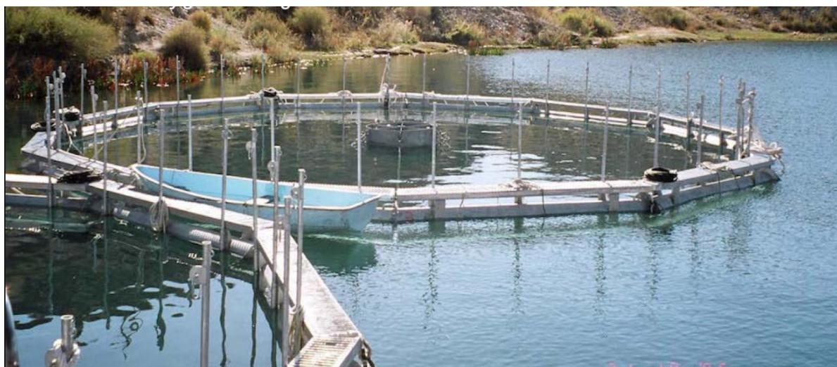
**Slika 14.** Poligonalni kavez za uzgoj ribe (Izvor: FAO, 2011)
