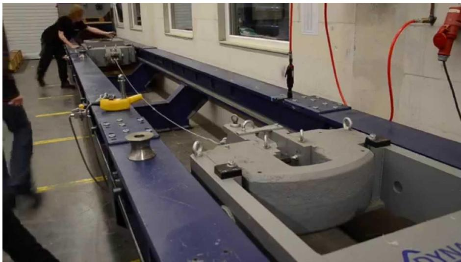
**Slika 22.** Ispitivanje prekidne čvrstoće materijala (Izvor: [www.riggerne.com](http://www.riggerne.com))
