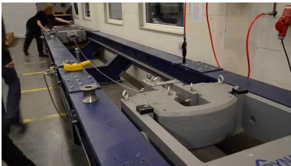
Slika 22. Ispitivanje prekidne čvrstoće materijala (Izvor: www.riggerne.com )
