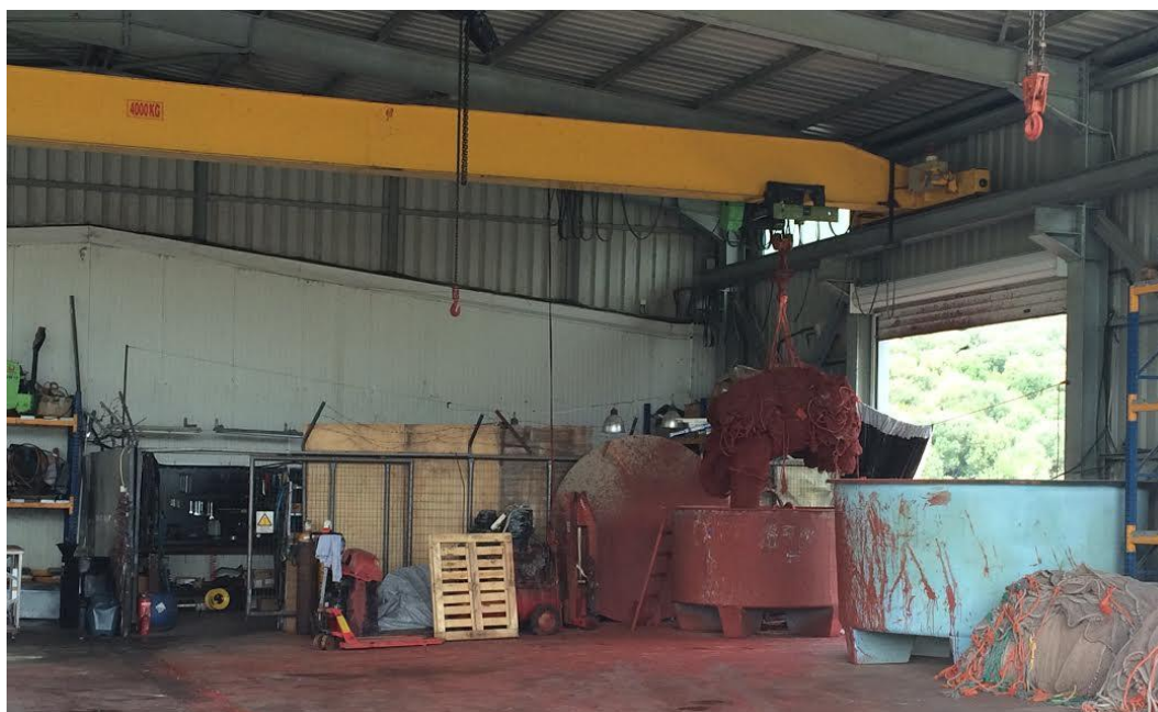
Slika 34. Nanošenje protuobraštajne boje na mrežni teg (Izvor: osobni foto materijal)
