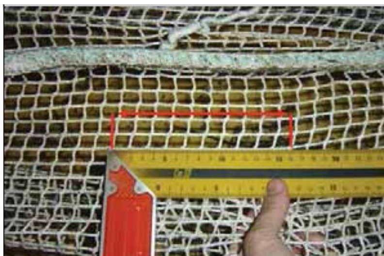
Slika 25. Mjerenje veličine oka (Izvor: FAO, 2015)
