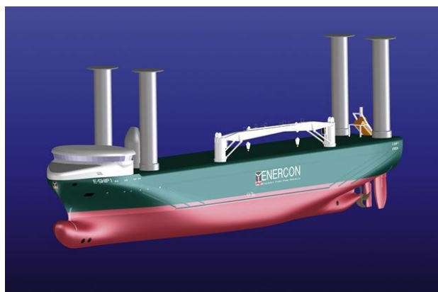
Slika 46. Flettner rotor on E Ship1
