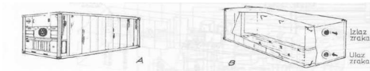
Slika 4 . A - prikaz integralni rashladni kontejner (sadrži svoj rashladni agregat za hlađenje), B - kolektivni rashladni kontejner (hlađen iz rashladne jedinice na brodu)[8]
