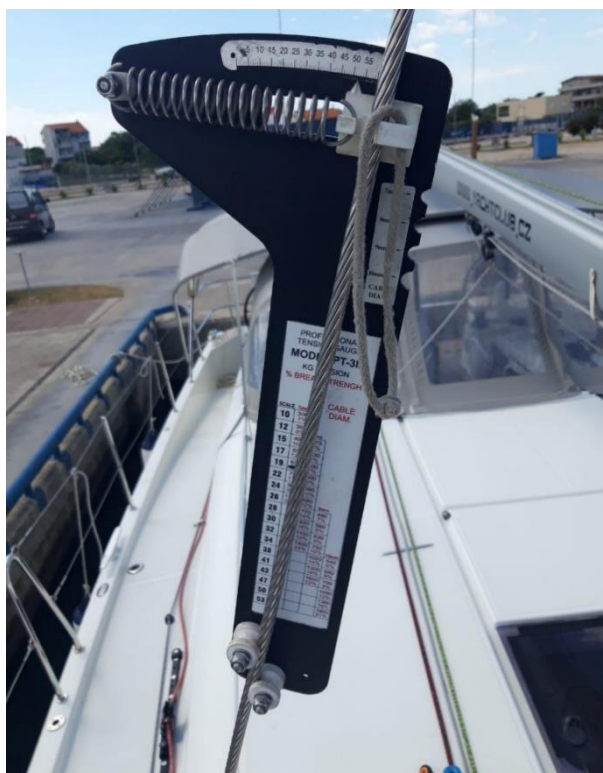
Slika 22: Tenziometar (izvor: autor)
