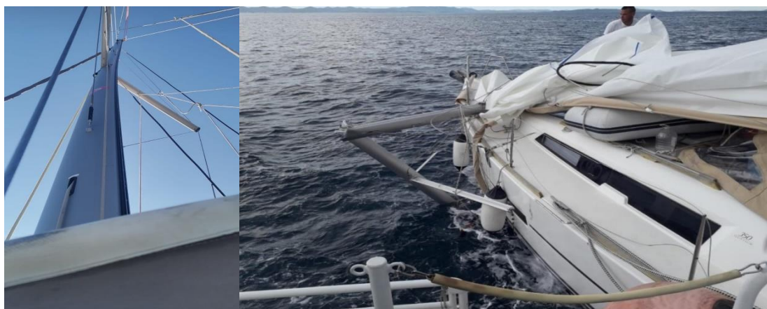
Slika 23: Iskrivljen (lijevo) i puknut jarbol (desno) (izvor: autor)
