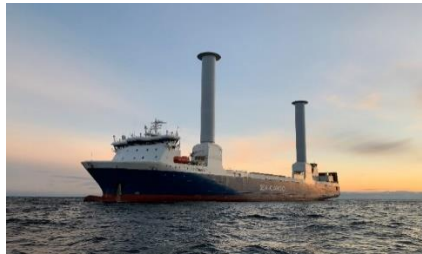
Slika 34: Cilindrični vertikalni stupovi na brodu (izvor: internetska stranica Nefco)
