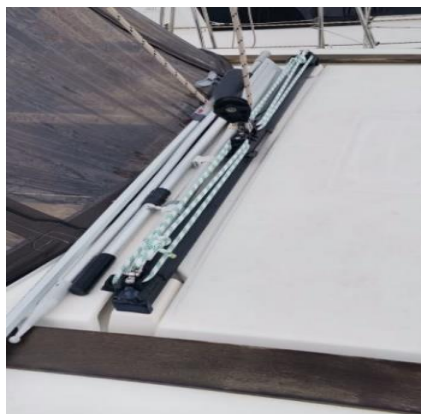
Slika 24: Tračnica glavnog jedra na brodovima u čarteru (izvor: autor)
