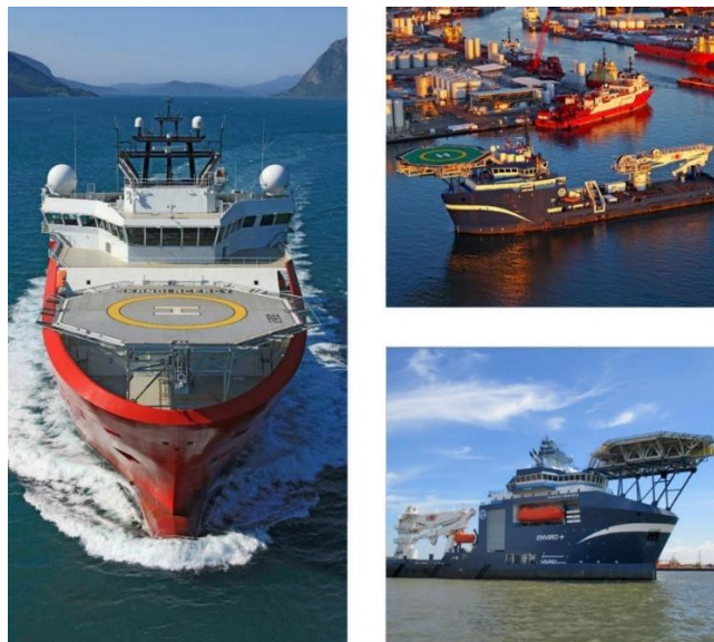
Slika 6. Primjer izvedbe helikopterskih paluba
