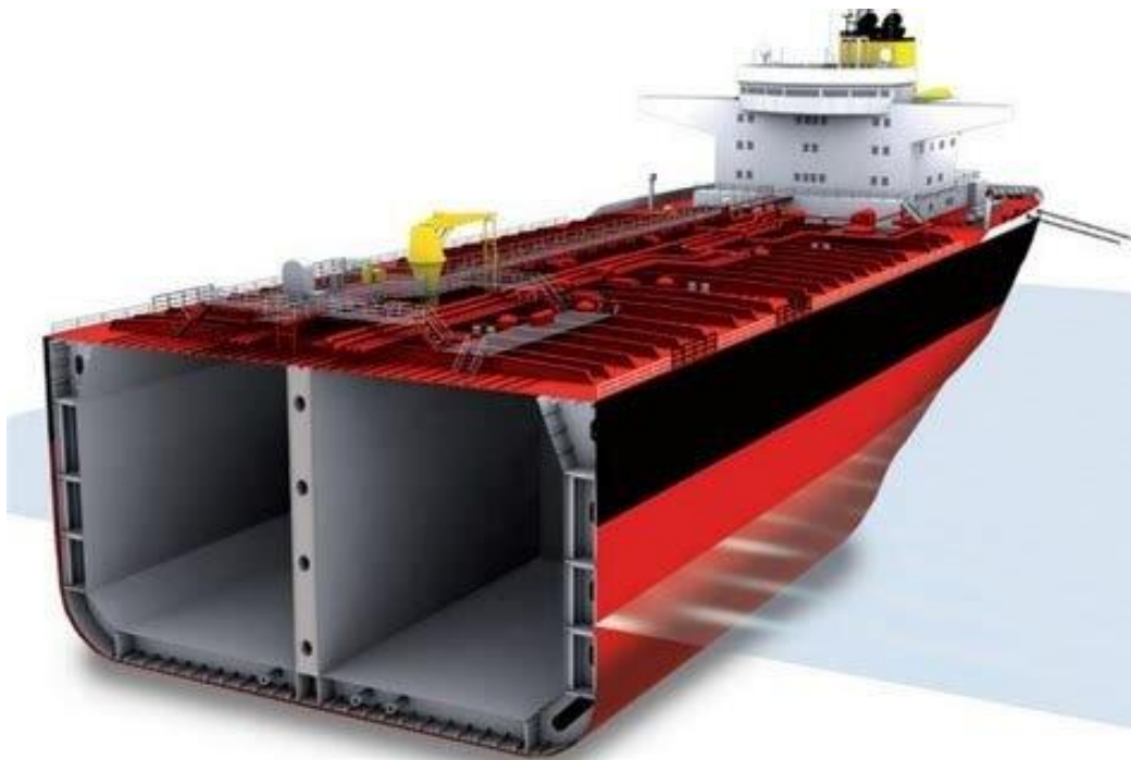
Slika 3. Primjer konstrukcije s dvostrukim trupom
