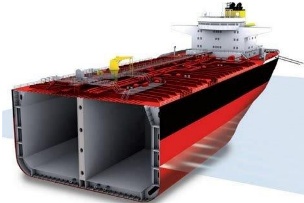
Slika 3. Primjer konstrukcije s dvostrukim trupom
