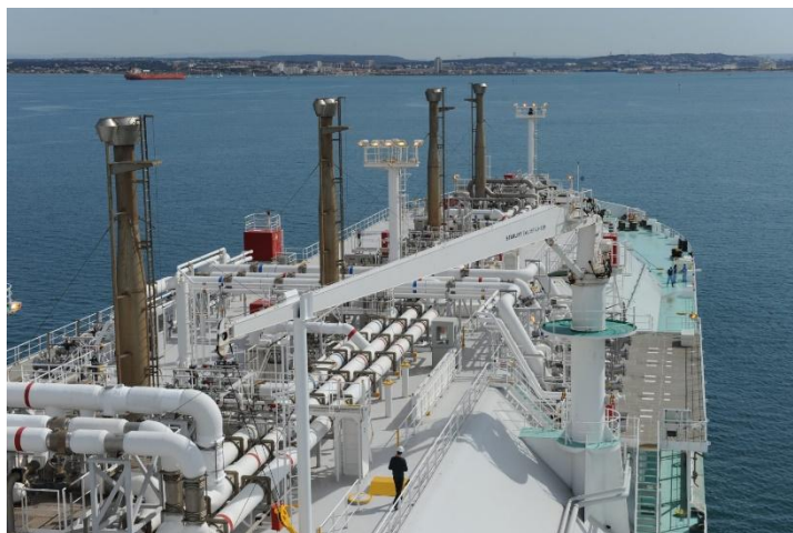
Slika 4 prikazuje palubni dio broda s cjevovodima broda za prijevoz ukapljenog plina, ( https://www.caleaeuropeana.ro/eurostat-importurile-ue-de-produse-energetice-in-continuu-scadere-norvegia-si-sua-principalii-furnizori-de-gaze-naturale-si-gnl/ )
