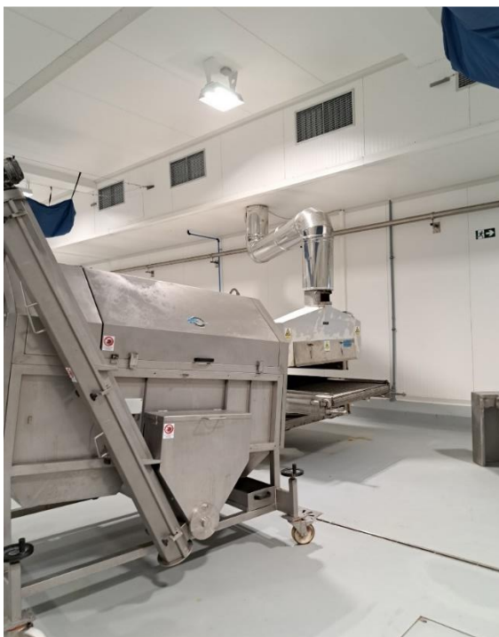
Slika 3. Tunel za brzo zamrzavanje (Izvor: Autor)
