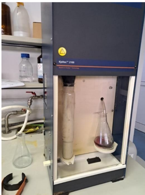
Slika 4. Aparat za destilaciju (Izvor: Autor)
