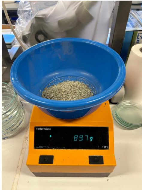
Slika 22. Vaganje sedimenta. (izvor: autor)
