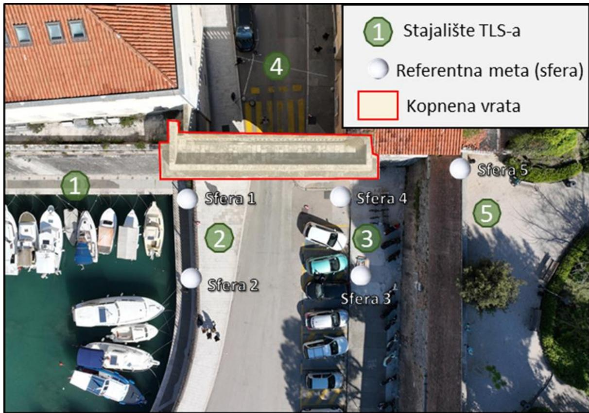
Slika 22. Plan skeniranja TLS-om
