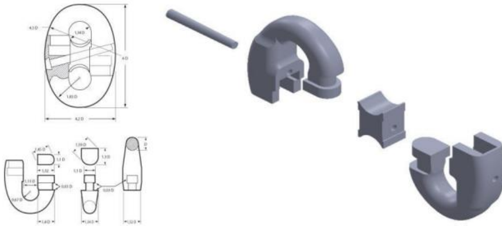
Slika 15. Patentna spojna karika tipa kenter
