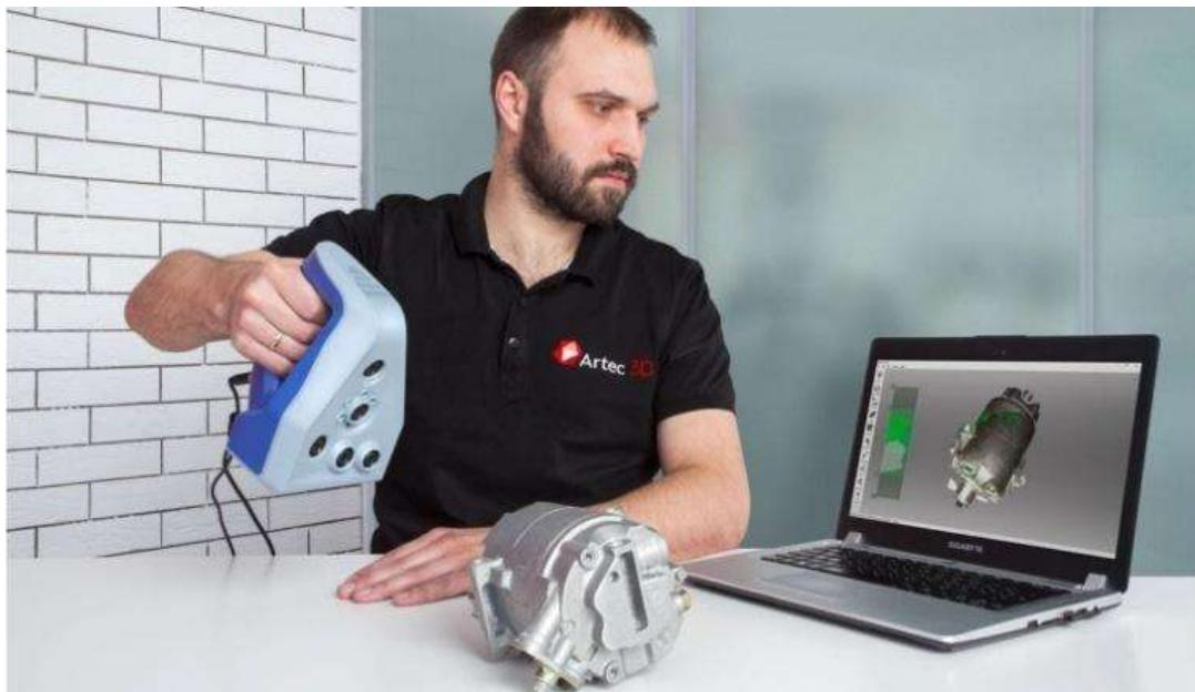
Slika 5. Generiranje modela korištenjem ručnog skenera (URL16)
