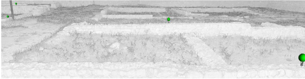
Slika 32. Prave referentne sfere na lokaciji snimanja
