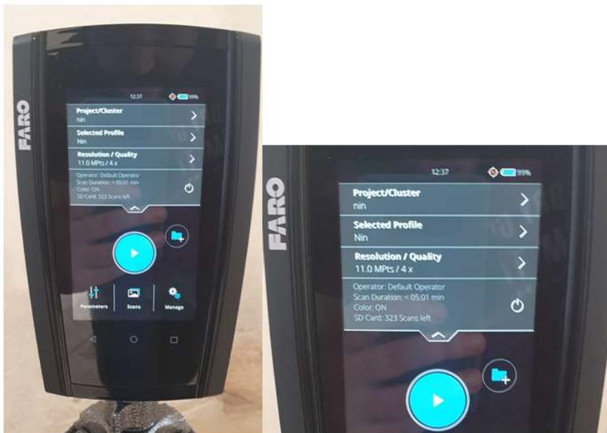
Slika 22. Sučelje s postavkama skeniranja na uređaju Faro Focus<sup>m</sup> 70
