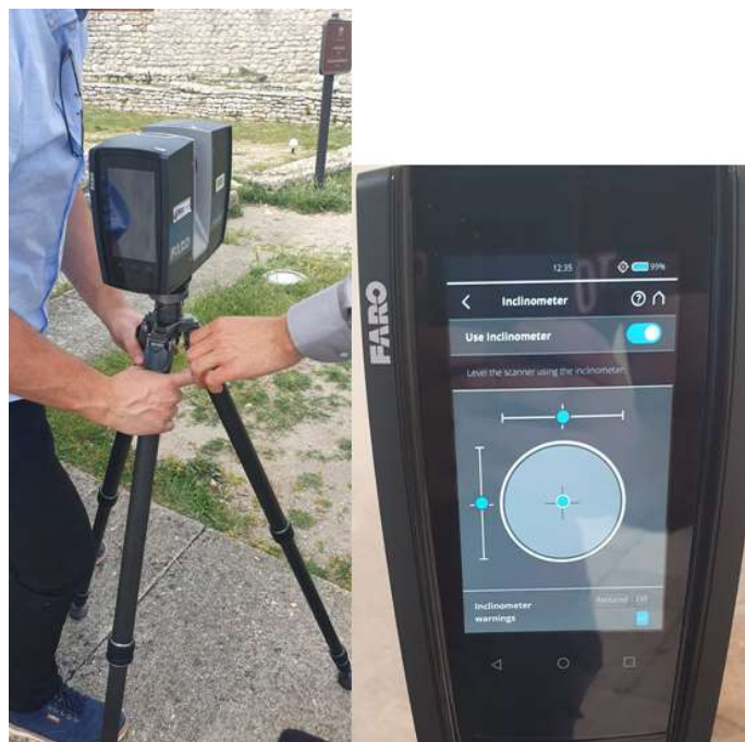
Slika 23. Postavljanje i kalibracija uređaja Faro Focus m 70
