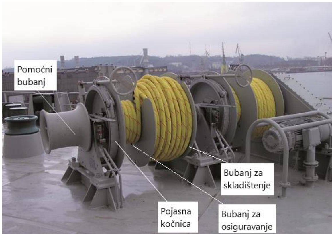
Slika 2. Podijeljeno pritezno vitlo s više bubnjeva [4]
