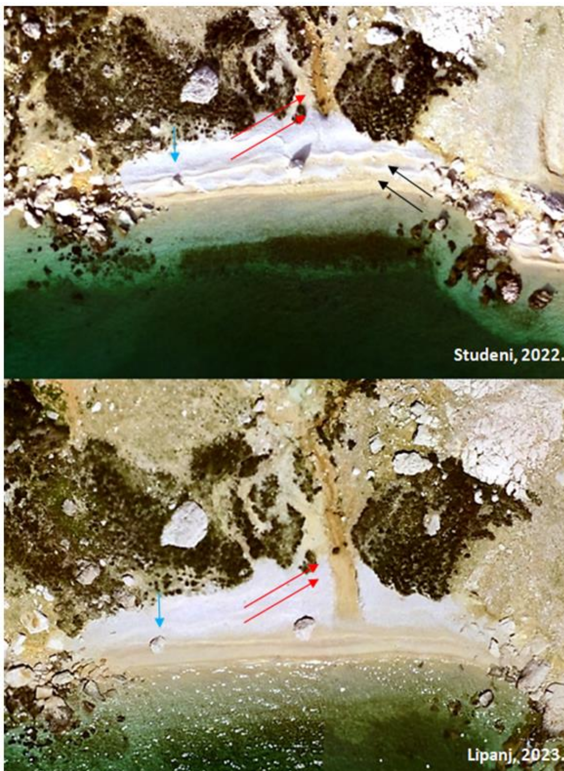
Slika 47. Promjena morfologije žala uvjetovana površinskim otjecanjem
