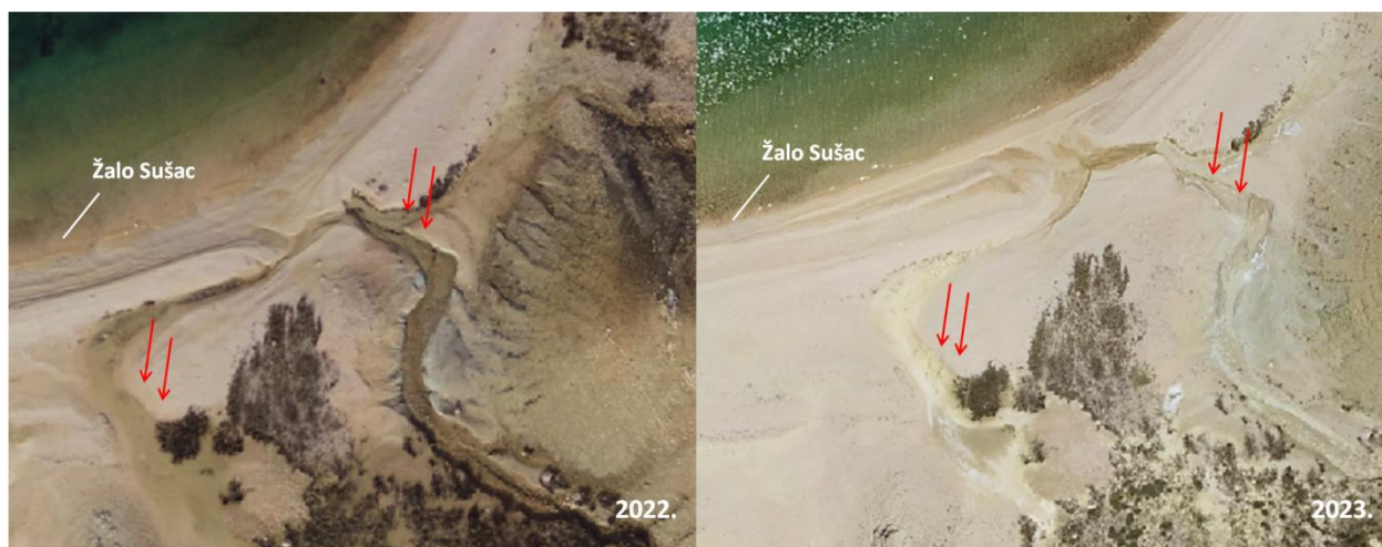
Slika 41. Utjecaj povremenog površinskog toka na preoblikovanje materijala uz područje istraživanja
