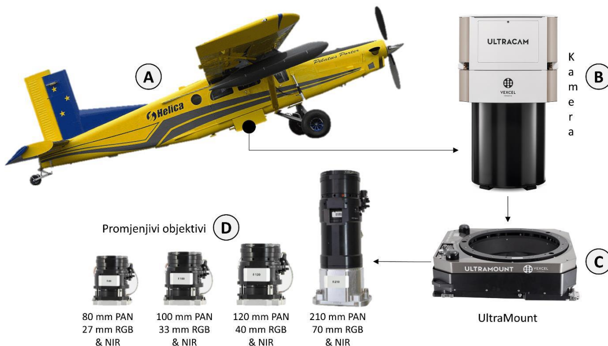
Slika 12. Komponente aerofotogrametrijskog sustava (Domazetović, 2021)
