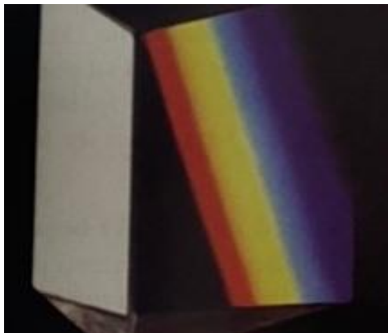
Slika 1. Disperzija svjetla kroz staklenu prizmu (Ivančević, 1997 :169)
