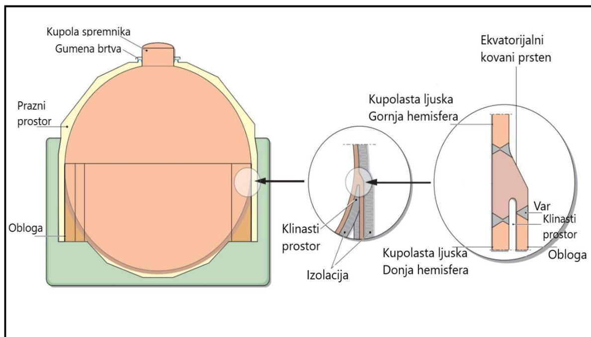
Slika 14. Konstrukcija sferičnog spremnika. [8]
