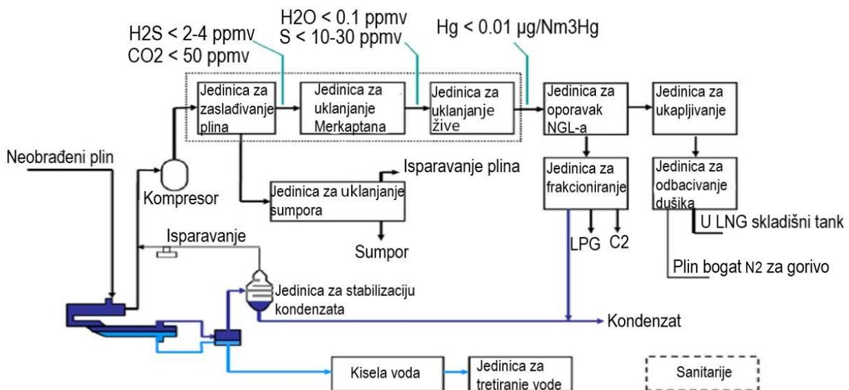
Slika 2. Shema postrojenja za proizvodnju LNG-a [1]
