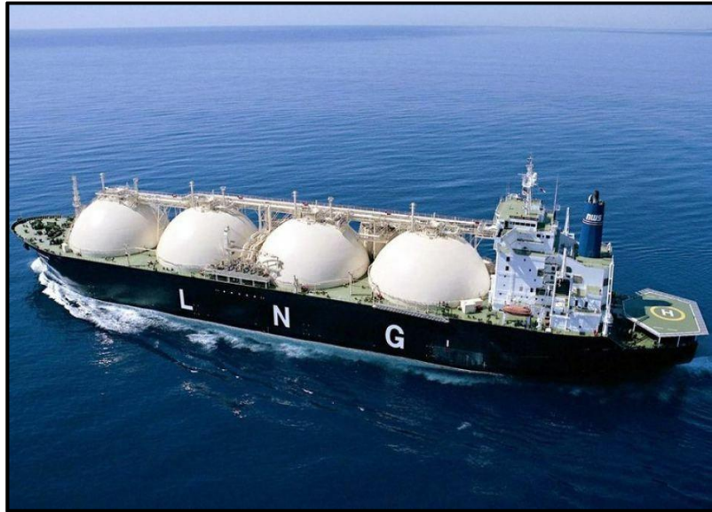
Slika 7. Brod za prijevoz ukapljenog prirodnog plina. [4]
