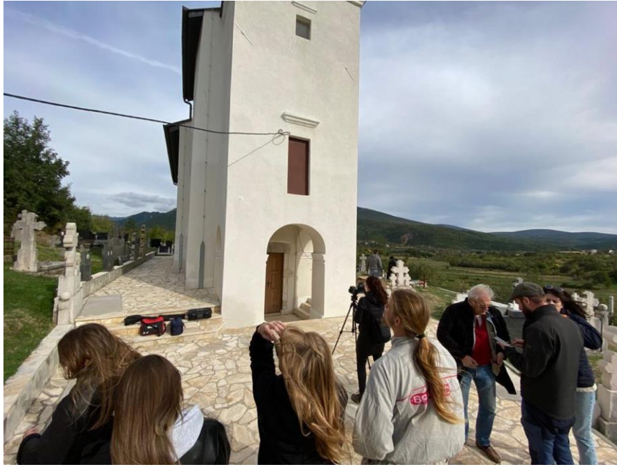
Prilog 28. Snimanje pročelja crkve termovizijskom kamerom, foto: Dolores Perković
