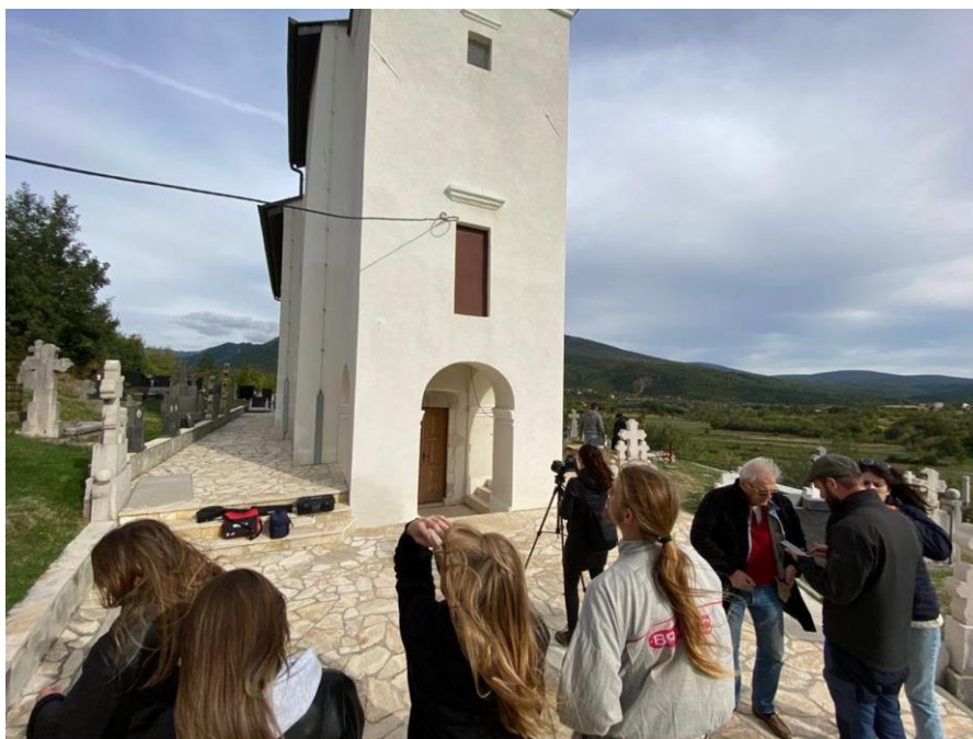
Prilog 28. Snimanje pročelja crkve termovizijskom kamerom, foto: Dolores Perković
