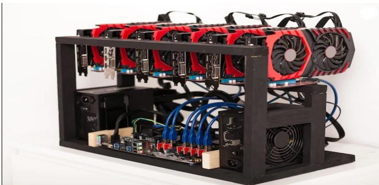
Slika 5: Platforma za „rudarenje“ putem grafičkih procesorskih jedinica
