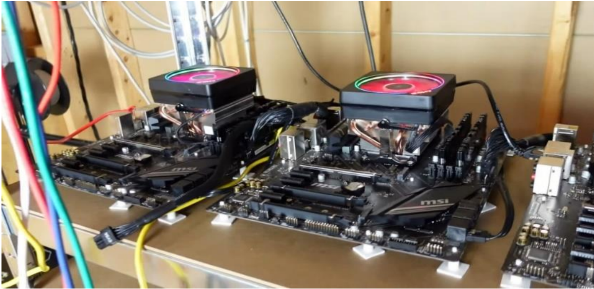
Slika 4: Platforma za „rudarenje“ putem centralnih procesorskih jedinica
