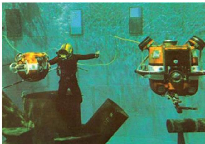
*Slika 20. Ronilice RCV 225 i RCV 150*
