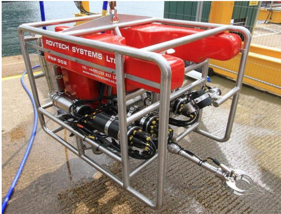
*Slika 22. RSL Workclass Seaker ROV*
