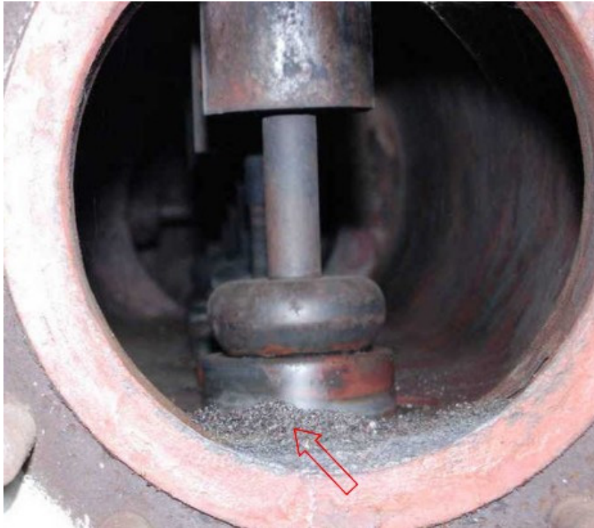
Slika 3. Kamenac na parnom ventilu [14].
