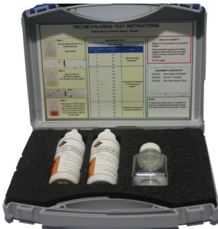
Slika 2. Pribor za mjerenje koncentracije kloridnih iona u vodi brodskih generatora pare [9].
