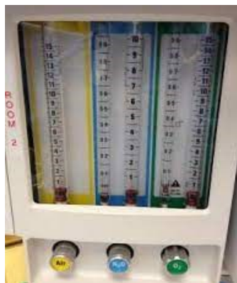
Slika 6. Mjerač protoka anestezijskih plinova
