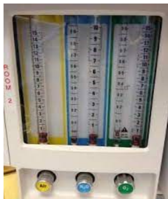
Slika 6. Mjerač protoka anestezijskih plinova
