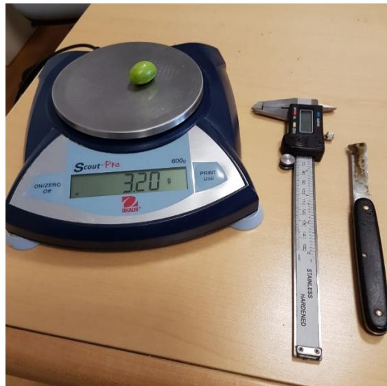
Slika 2. Digitalna vaga i pomična mjerka (Izvor: B.Vrkić, 2020.)
