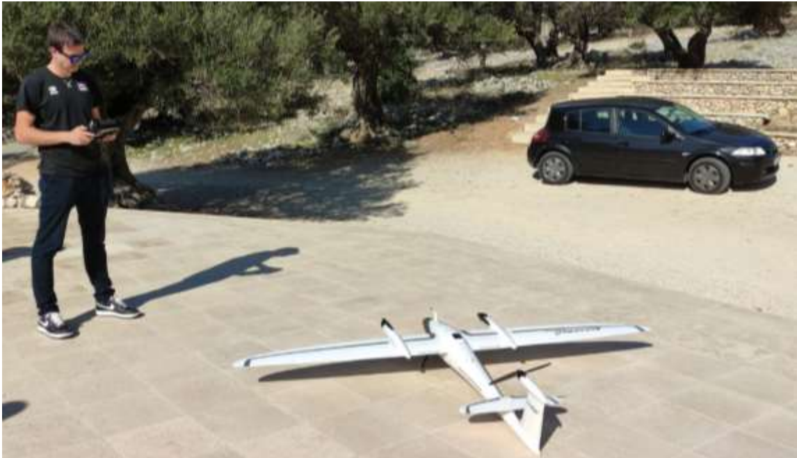
Slika 4. Bepilotna letjelica Trinity F90+
