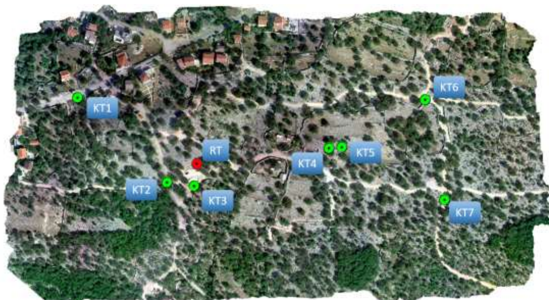
Slika 11. Prostorni raspored kontrolnih točaka i lokacija referentne točke
