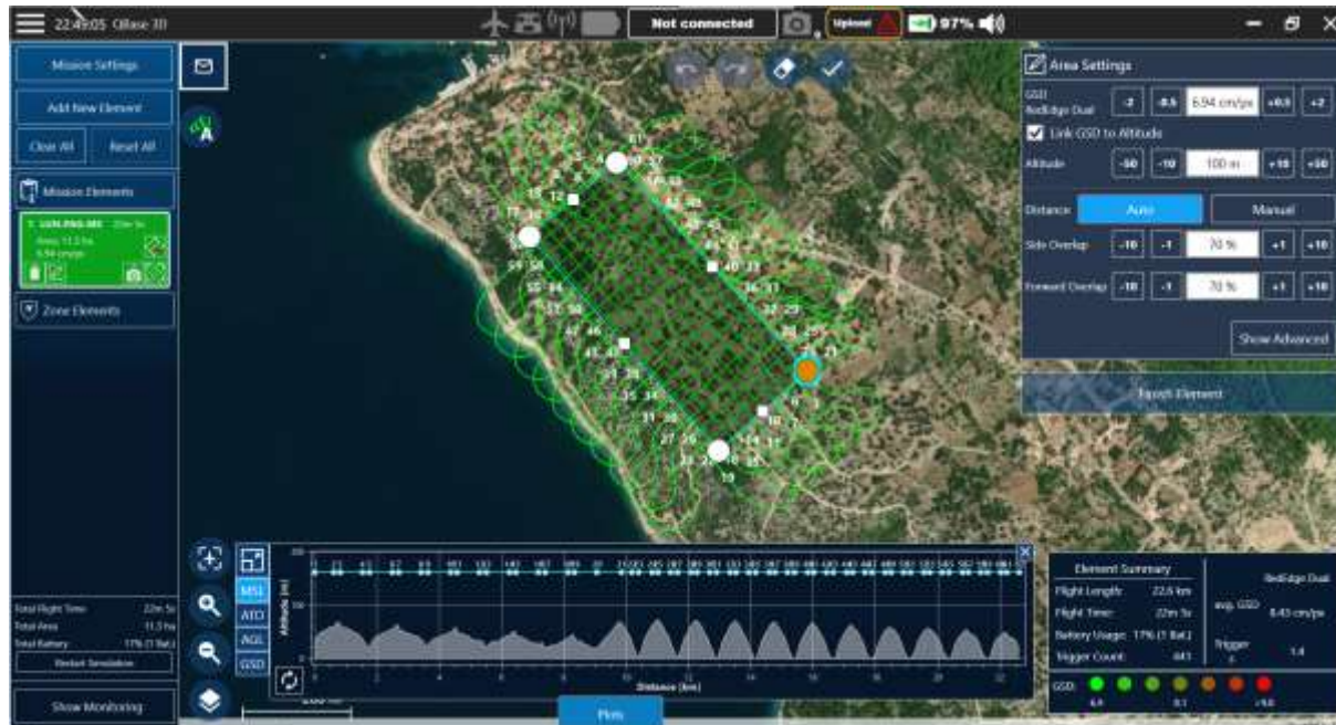
Slika 17. Plan i postavke misije s multispektralnim senzorom
