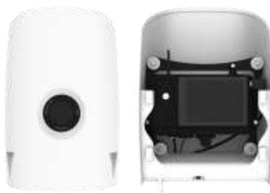
Slika 7. Sony RX1R II fotoaparati u kućištu spremnom za postavljanje na bespilotnu letjelicu (URL8)
