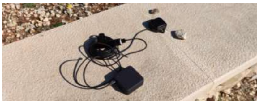
Slika 12. Referentna točka i bazna stanica iBase
