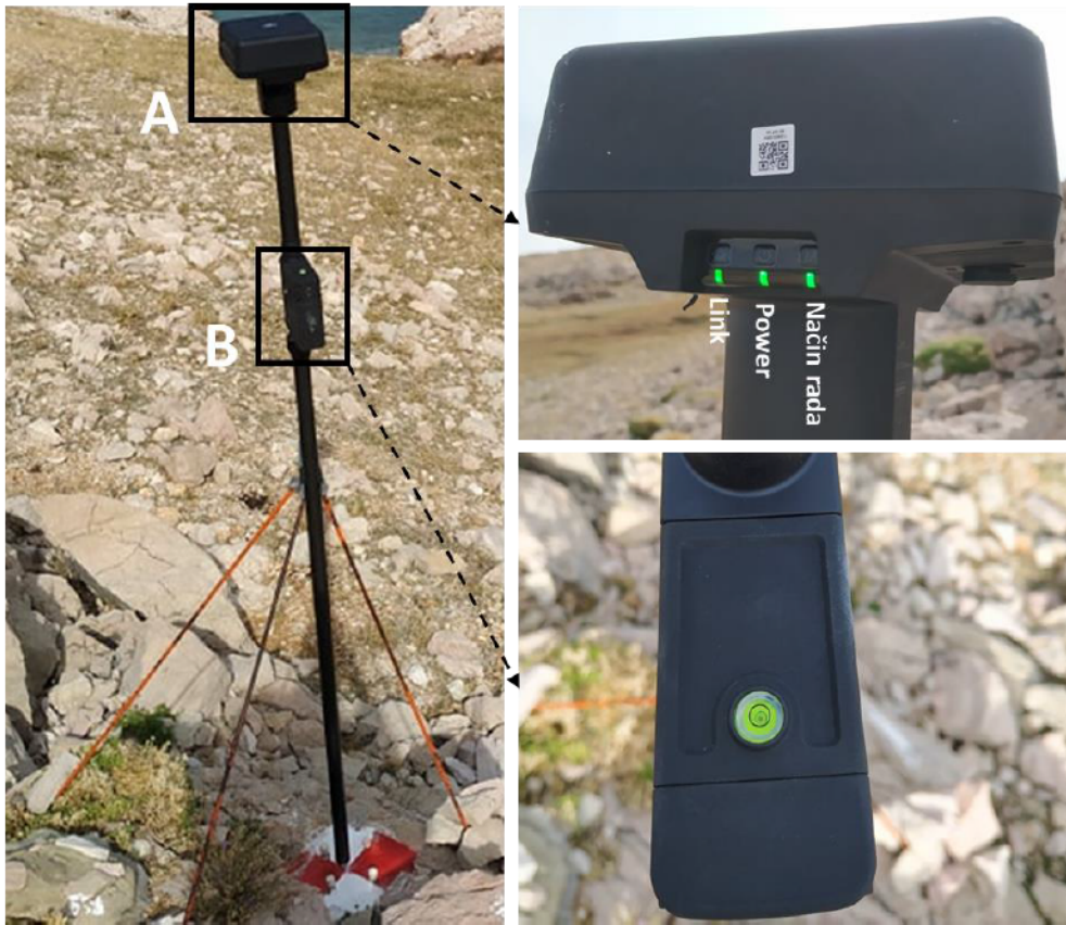
Slika 13. Montirana D-RTK mobilna stanica
