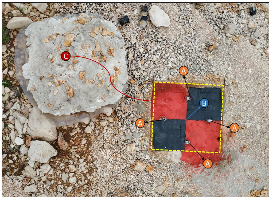
Slika 78. Gipsana kapa za prikrivanje i zaštitu izrađenog stalnog postolja (A – sidrišni vijak; B – središte nosača za metu; C – gipsani zaštitni poklopac)
