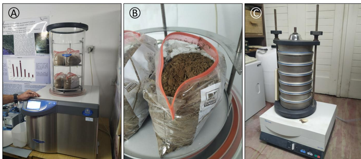
Slika 71. Sušenje prikupljenih uzoraka (B) u Labconco FreeZone 8L zamrzavajućoj sušilici (A); Prosijavanje prikupljenog sedimenta uz pomoć Retsch AS 200 sita
