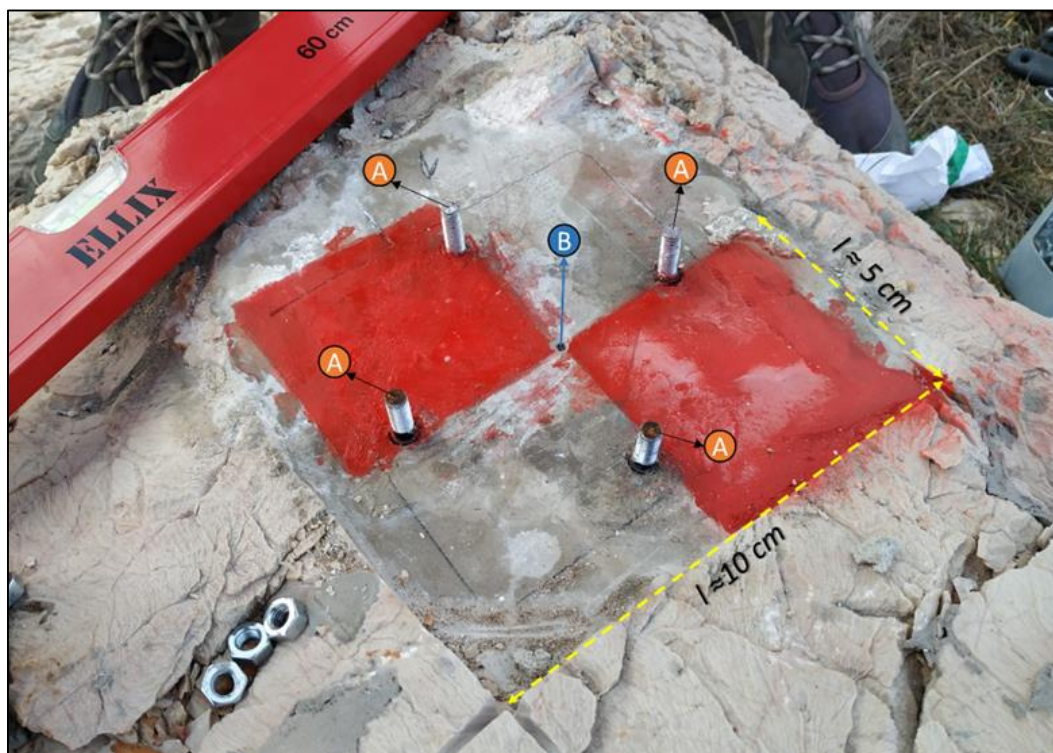
Slika 76. Izrađeno stajalište za metalni nosač referentne mete (A – sidrišni vijak za fiksiranje nosača; B – središte nosača za metu (sferu))
