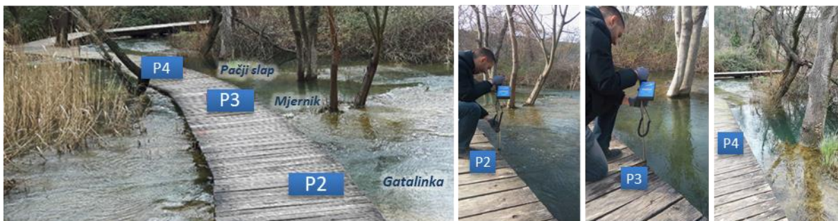
Slika 61. Mjerenje brzine protoka vode na lokacijama P2-P4 (kod Marasovića jezera)
