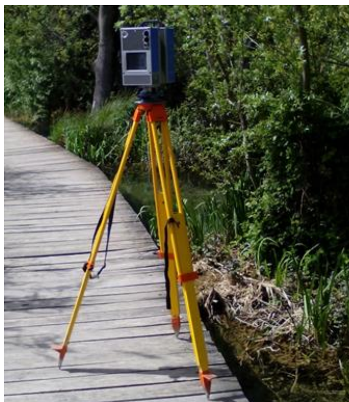
Slika 42. Z+F Imager5600i na odabranoj testnoj plohi
