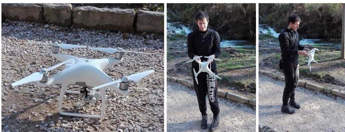
Slika 54. Kalibriranje sustava senzora Phantoma 4, ožujak, 2018
