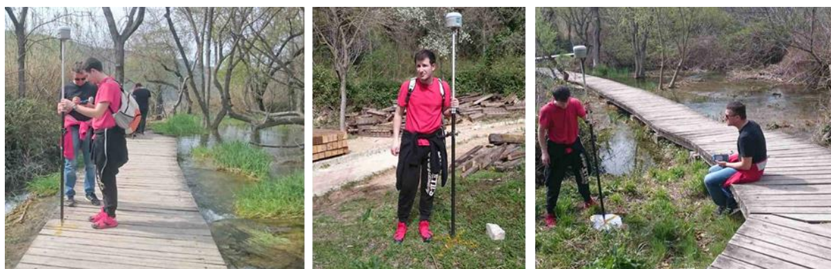
Slika 52. Prikupljanje točaka lokalne geodetske osnove, ožujak 2017. godine
