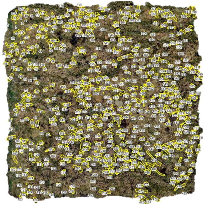
Slika 174. Detektirani mikroorganizmi na površini PL25 (lipanj, 2018)
