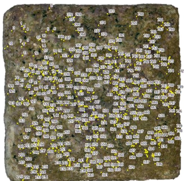
Slika 176. Detektirane mikro rupice na površini sedre PL25 (prosinac, 2018)
