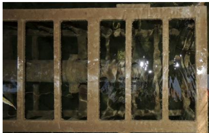
Slika 66. Osedreni kavez i sonda nakon dvadesetak dana izloženosti toku
