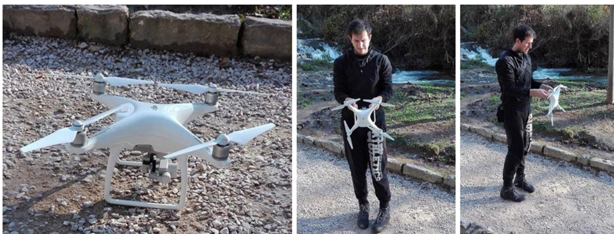
Slika 54. Kalibriranje sustava senzora Phantoma 4, ožujak, 2018
