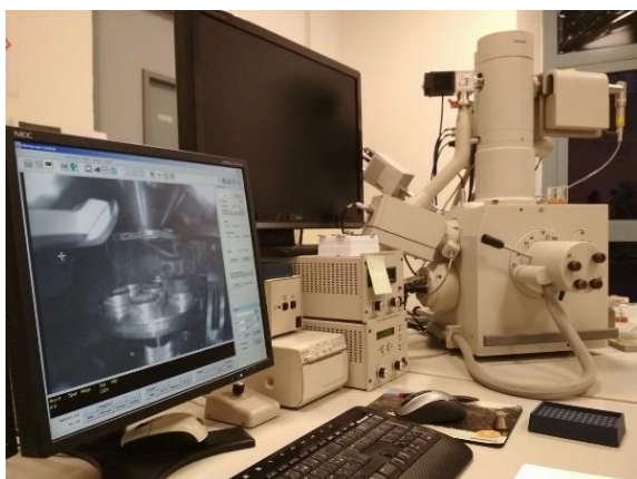
Fig. 4-20. SEM Philips xl 30, EDX Detector Apollo 10 SDD (photo: K. Batur).
