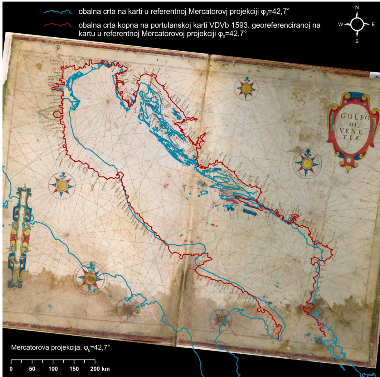
Slika 4—2. Karta VDVb 1593. georeferencirana na kartu u Mercatorovj projekciji ( \varphi_0=42,7^\circ ) kao referentnu plohu metodom LSE i korištenjem konformne 4-parametarske transformacije.
